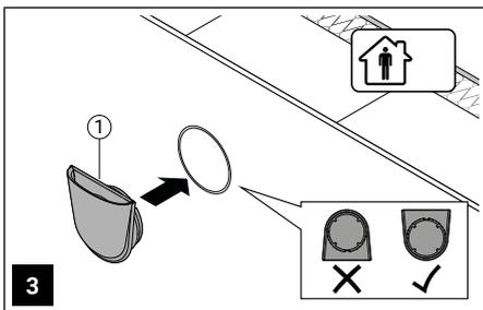
Die Innenblende mit der Öffnung nach oben in das Montagerohr stecken.
