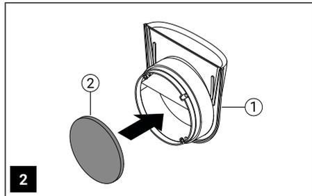
Setzen Sie den Filter in die Filterhalterung der Innenblende ein.
