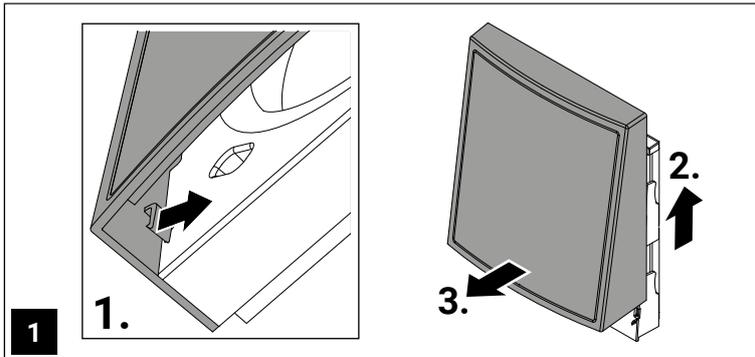
Lösen Sie die beiden inneren seitlichen Rasthaken (1) im Cover und ziehen Sie das Cover vom Rahmen zuerst etwas nach oben (2) und dann nach vorne ab (3).
