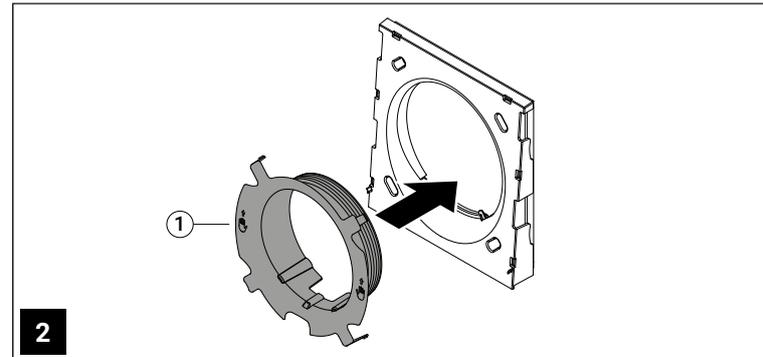
Stecken Sie den Steckadapter von vorne in den Rahmen. Achten Sie darauf, dass die vier Rasthaken des Steckadapters im Rahmen einrasten.
